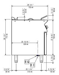
Electrical inlet (power) EQ Equipotential screw
